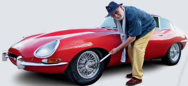
Zum Lösen der Flügelmutter sind teilweise hohe Kräfte erforderlich. Mit der  $\frac{3}{4}$ "-Knarre und der Verlängerung gehört dies der Vergangenheit an.
