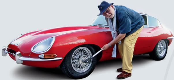
Desserrer l'écrou papillon nécessite en partie le recours à des forces puissantes. La clé à cliquet 3/4" et sa rallonge relèguent ce problème à un lointain passé.
